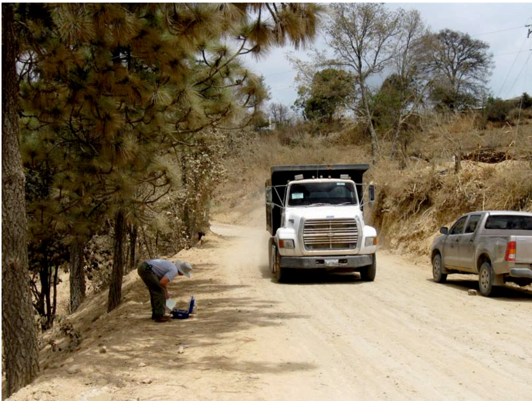
Figura 12b Monitoreo de Vibraciones de Vehiculos
