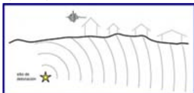
Figura 1. Diagramas simplificados del esquema de mediciones de amplitudes de ondas sísmicas para detonaciones superficiales (A) y en la Mina subterránea (B). En ambos casos se presumen características distintas de la propagación de ondas sísmicas y asimismo de las condiciones logísticas de levantamiento de datos.
